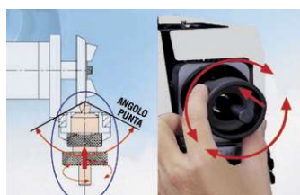
Regolazione della lunghezza e posizionamento della punta
